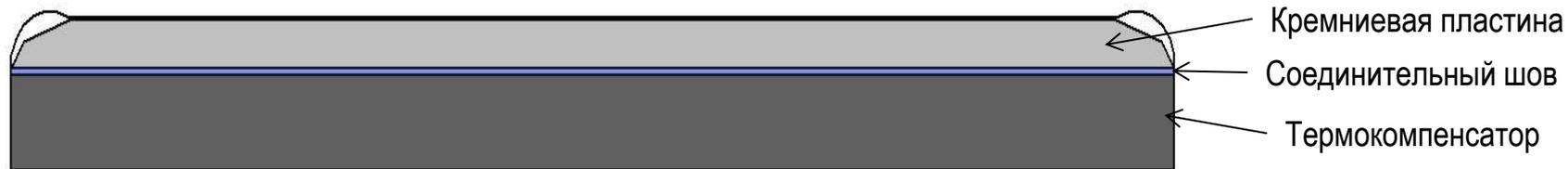
Диапазон диаметров кремниевых пластин: *от 24 до 100 мм;*
